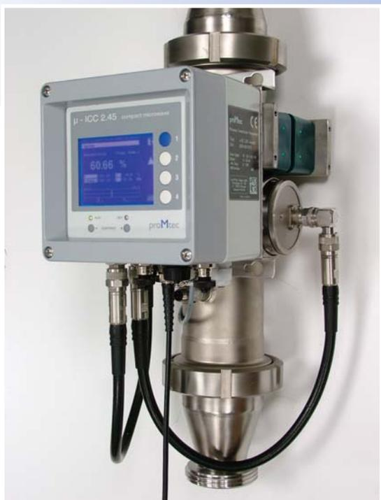
De forma alternativa a este concepto, está disponible el  $\mu$ -ICC 2.45 standard, que consta de 3 componentes. Aporta una gran flexibilidad y permite hasta cuatro mediciones con un solo controlador (información detallada bajo demanda).
